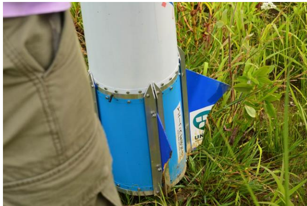
Fig. 2.2.9 フィンの破損
