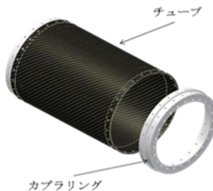
Fig. 2.2.2 GFRP チューブとアルミ合金カプラリング
