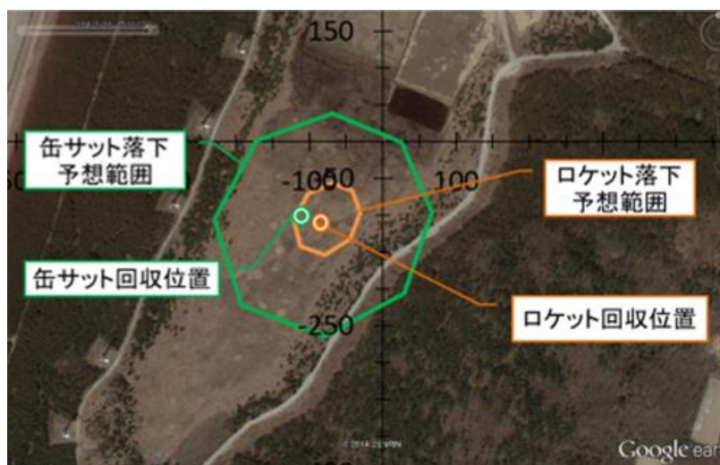
Fig. 2.8.7 機体とペイロードの回収座標
