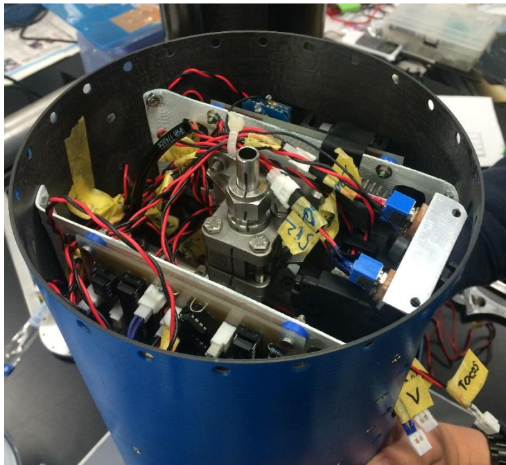
Fig. 4.2.8 搭載した制御回路
