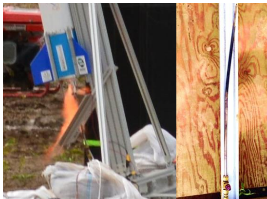
Fig. 6.5.4 噴射炎制御の様子と変形したランチャシステム
