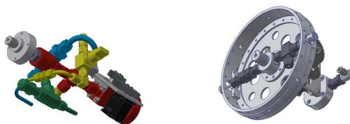
Fig. 6.2.5 H-36 搭載型バルブシステム (左), H-40 搭載型バルブシステム (右)
