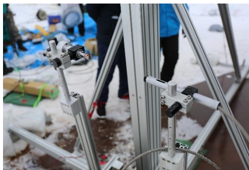
Fig. 6.2.7 バルブ地上設備とランチャ（打上げ後）
