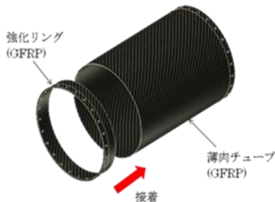
Fig. 2.2.3 強化リングと薄肉チューブ
