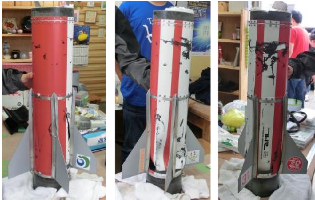
図 2.9 モータチューブ部分の損傷状況
