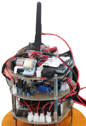
図 2.25 H-31 共通計器（下段）テレメータ（上段）外観
