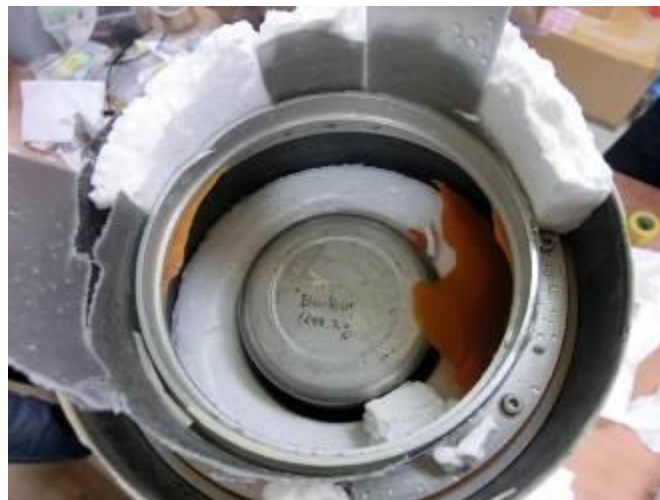
図 2.8 N_2O タンク上部から見た機体の破損状況
