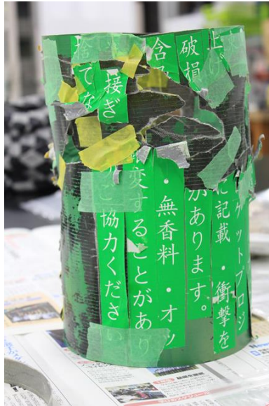
図 2.12 回収した破片を組立てた状態
