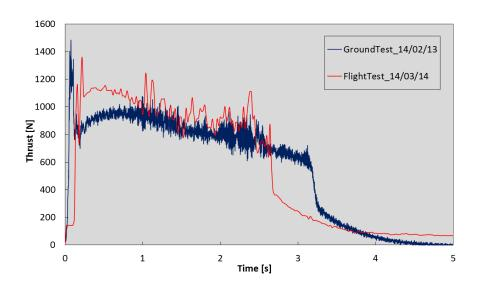
資料 4. 地上燃焼試験結果とデジタルセンサ取得値の比較
